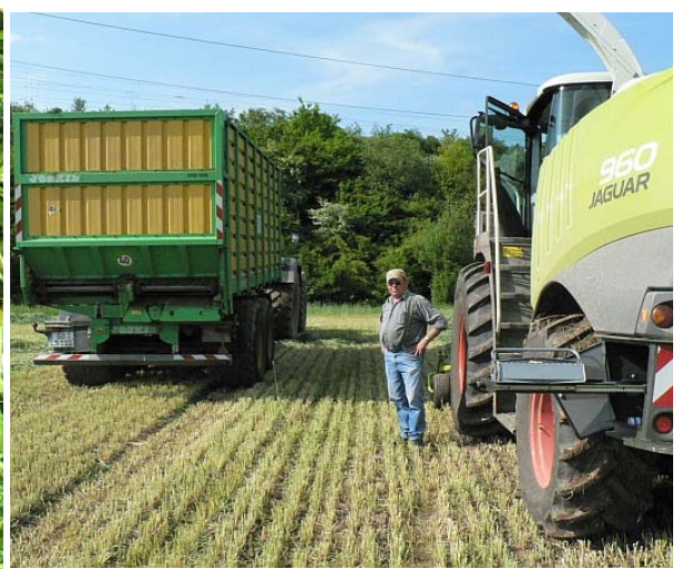
Der selbstfahrende Mäh-Aufbereiter (knickte und riss die Halme an) hatte 365 PS, der Häcksler 620 PS. Ohne großen Radlader im Silo sind die Mengen nicht sinnvoll zu verdichten. Eine Biogasanlage ähnelt in der Außenwirtschaft einem großen Milchviehbetrieb, da kann die Futterbergung auch nicht mehr allein gemacht werden, kommen die Lohnunternehmer immer stärker zum Zug.
