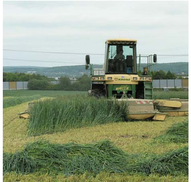
Der 120 cm hohe Roggen wird mit einem selbstfahrenden Mäh-Aufbereiter gemäht. Stundenleistung bis 15 ha - bei großen Feldern.
