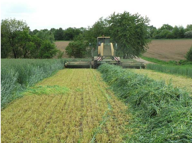
Der 120 cm hohe Roggen wird mit einem selbstfahrenden Mäh-Aufbereiter gemäht. Stundenleistung bis 15 ha - bei großen Feldern.
